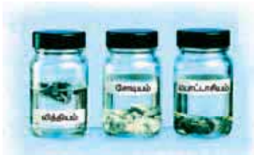
படம் 5.1 கார உலோகங்கள் Li, Na, மற்றும் K ஆகியன மண்ணெண்ணெயில் சேமிக்கப்பட்டுள்ளன.
